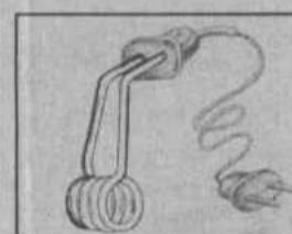
устранить эту неисправность несложно. Надо распилить тонкой пилкой опрессовку ввода и освободить провод. Концы его припаять к выводам нагревателя и на место ввода установить штепельную вилку.
