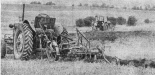
Венгерский учитель Иштван Альберт сконструировал трактор, работающий без водителя. Трактор работает по принципу копира, напоминающего принцип работы фасонно-токарного станка. Для начала работы такого трактора тракторист проводит только первую борозду, в которую затем помещается планический прибор. Последний следит за линии борозды. При какой-либо неполадке трактор останавливается и подает сигнал.
